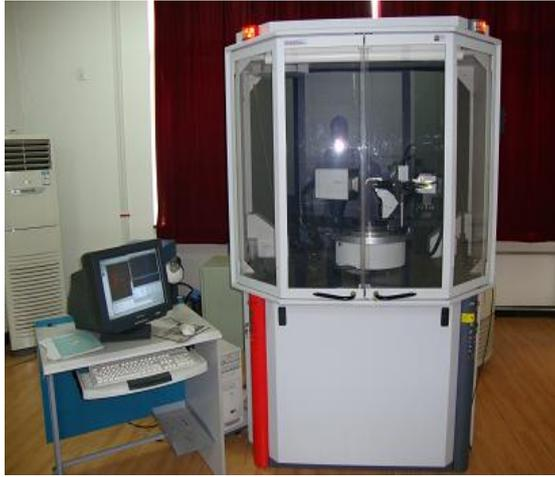
图 2-1 X-射线单晶衍射仪
